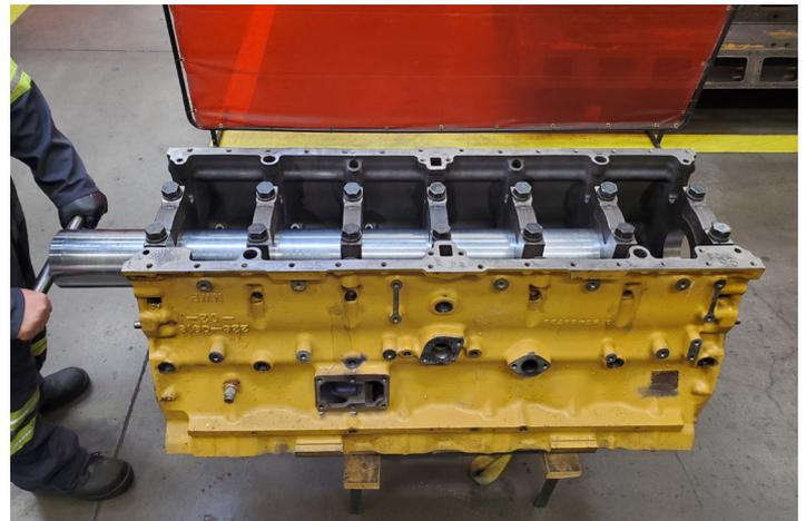
Confirmación de las aleaciones adecuadas del diámetro interior del rodamiento principal
