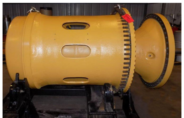
Grupo de ruedas trasero CAT 793 después de la re fabricación de H-E Parts
